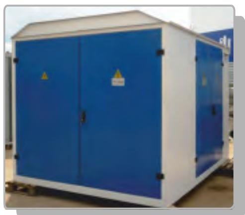
В плане комплектации оборудованием, предлагается широкий выбор исполнений распределительных устройств высокого напряжения: глухой ввод (без коммутационного аппарата), тупиковые и проходные, с воздушным и кабельным вводом, выводом, а так же на базе ячеек КСО-399 с установленными выключателями типа: **ВНА** (Выключатель нагрузки автогазовый); **ВНР** (Выключатель нагрузки с ручным приводом); **РВЗ** (Разъединитель внутренней установки с заземляющими ножами)
